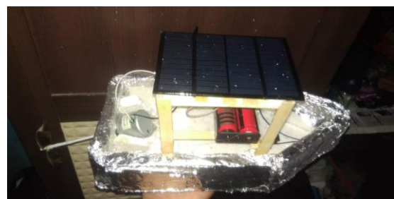
Gambar 2. Alat Peraga Kapal Tenaga Surya
