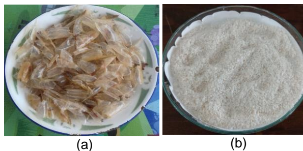
Gambar 1. Hasil isolasi kitosan dari kulit udang: (a) kulit udang, (b) kitosan
