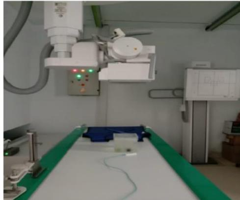
**Gambar 2.** Gambaran posisi phantom akrilik pada saat proses pengeksposan.
