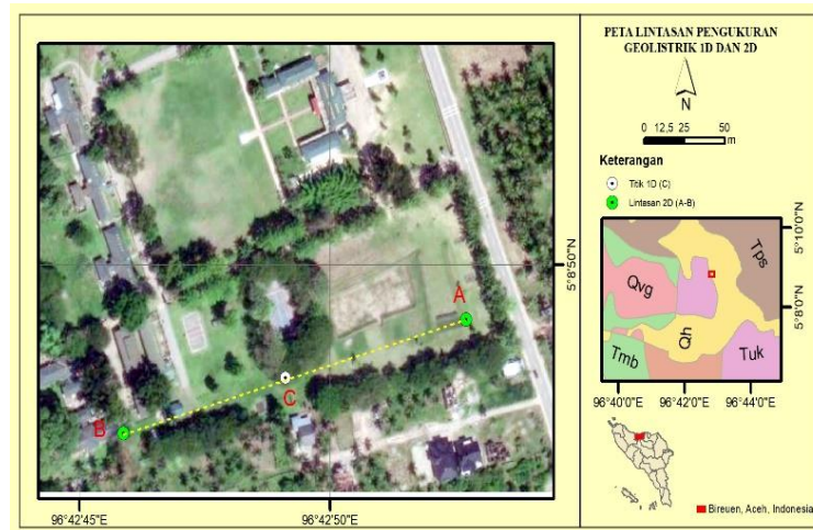
Gambar 1. Skema lintasan pengambilan data resistivitas 2D dan pengukuran 1D
