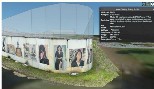
Gambar 9. Integrasi model 3D dengan metadata semantik pada website
