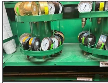
Gambar 8. Ruang Penyimpanan Alat Ukur Inspeksi Berdebu
