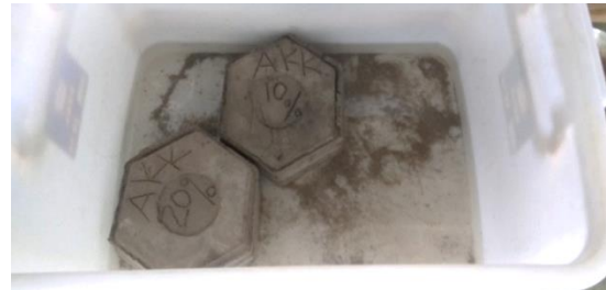
Gambar 2. Pengujian daya serap air
