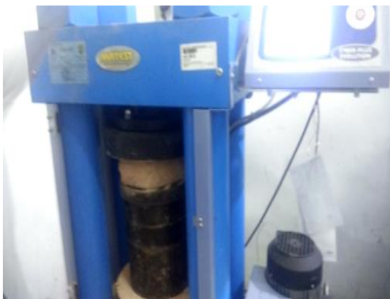
Gambar 4. Pengujian kuat tekan paving Block
