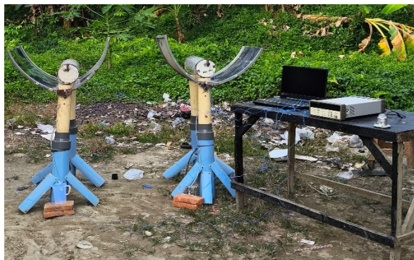
Gambar 1. Alat distilasi surya (Sumber: Foto Penelitian)
