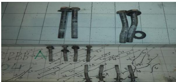
Gambar 4.9. Kerusakan baut profil canal(c)ferro foam concrete
