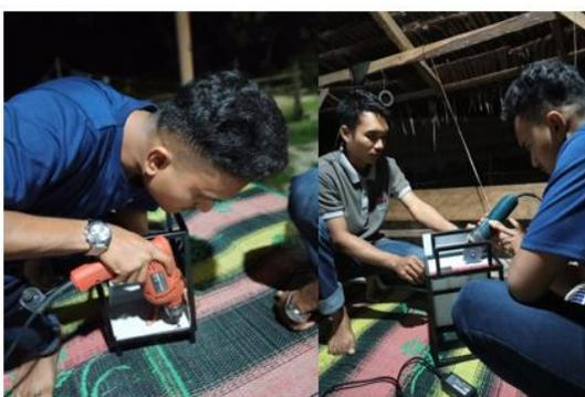
Gambar 3. Perakitan dinding kotak menggunakan komposit panel
