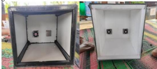
Gambar 3. Dinding dalam menggunakan Styrofoam
