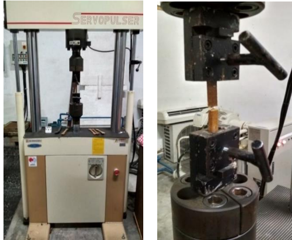
Gambar 6. Alat uji tarik universal
