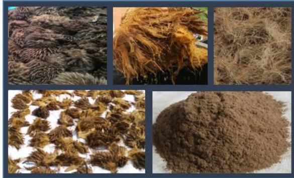
Gambar 4. Proses Pembuatan Serat Tandan Kosong Kelapa Sawit (TKKS)
