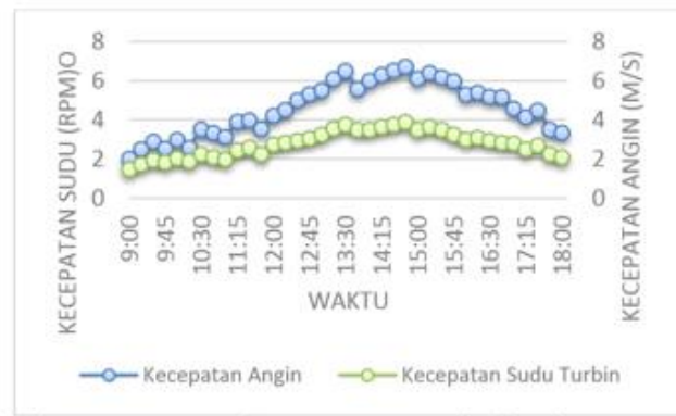
Gambar 3. Hubungan Kecepatan angin dengan sudu turbin
