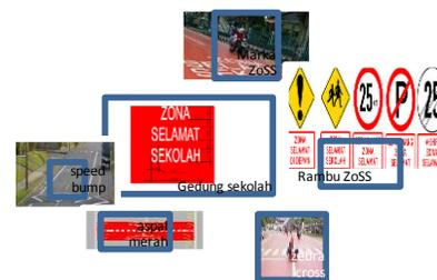
Gambar. 1. Kelengkapan standar pada ZoSS
