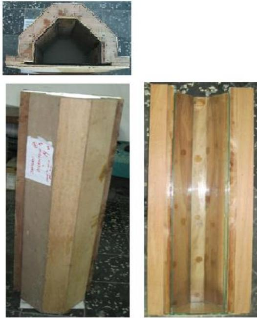
Gambar 4. Alat cetak struktur parking bumper
