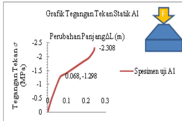
Gambar 10. Grafik tegangan - spesimen uji ke-1 pada sisi atas
