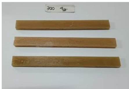
Gambar 5. Hasil Pembuatan Spesimen Uji Three Point Bending
