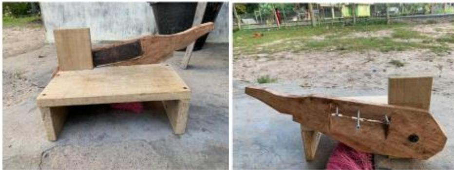
**Gambar 4:** Alat Pemotong Kerupuk Manual
